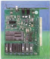
La scheda in una veduta di insieme: il chip commissionato con le etichette colorate approssimano le chiavi hardware per le varie applicazioni software.
